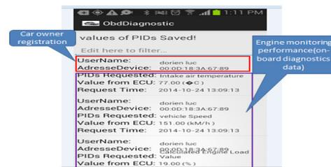
그림 6. 자동차 소유자가 클라우드에 저장 온보드 진단 데이터의 요청
