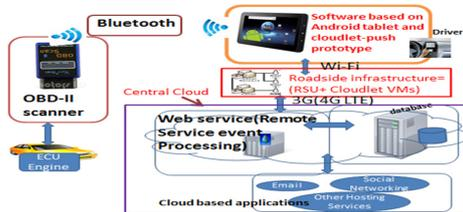
그림 4. 원격 차량 진단 모바일 응용 프로그램의 시스템 설계
